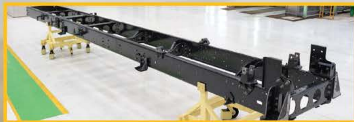
8.5 mm / 5 mm ද්විත්ව වැසිය 8.5 CHASSIS WITH FULL LENGTH 5 MM REINFORCEMENT
